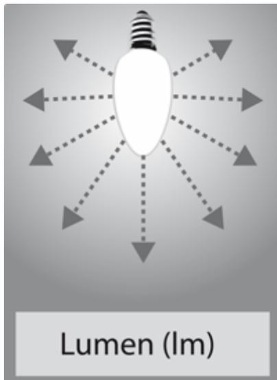
**Lumen** ist die Einheit für die „Lichtleistung“ einer Lampe. Also praktisch die Zusammenfassung allen Lichts, welches die Lampe nach allen Seiten ausstrahlt. Eine Glühlampe von 40 **Watt** strahlt in etwa 400 Lumen nach allen Seiten aus. Lumen ist wie Candela eine Sendergröße und beschreibt das Licht, welches von der Lampe ausgesendet wird.
