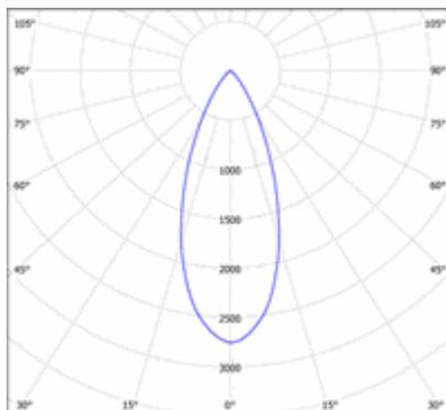
Aus dieser Lichtstärkeverteilungskurve geht hervor, dass die Leuchte ca. 2750 Candela senkrecht nach unten abstrahlt. Das heißt, dass in 3 Meter Entfernung noch 2750 cd geteilt durch (3m)<sup>2</sup> ankommt. Also noch ca. 305 Lux. Allerdings wird dabei nur diese eine Lampe betrachtet - kein Licht welches von anderen Lampen auf die Fläche fällt und auch kein Licht, das von Flächen (z.B. Wänden) reflektiert wird.
