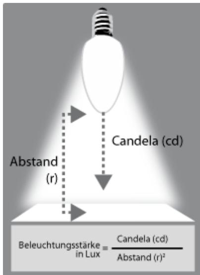
Mit Hilfe einer Lichtverteilungskurve (siehe unten) und einer kleinen Formel können Sie errechnen, wie viel Lux in welcher Entfernung noch ankommt. Dabei müssen Sie einfach die Lichtstärke (Candela) durch die Entfernung (in Meter) zum Quadrat rechnen. Hört sich kompliziert an - ist aber recht einfach.
